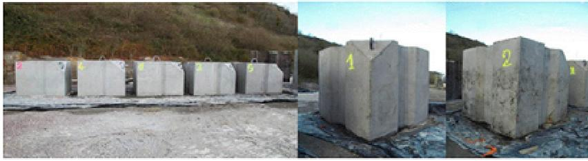
Illustration de la réussite de la reproduction d'un bloc naturel. Comparatif bloc naturel / blocs BSO préfabriqués :
