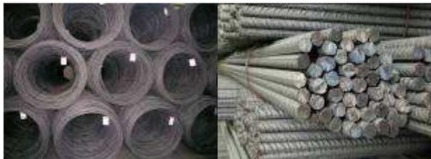
**Fer à béton (en rouleaux et en barres)**
