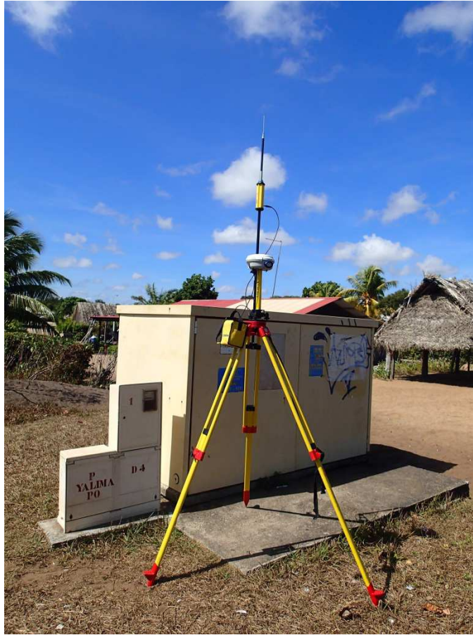
Illustration 2 – Station fixe du GPS positionnée sur un repère géodésique IGN à Yalimapo
