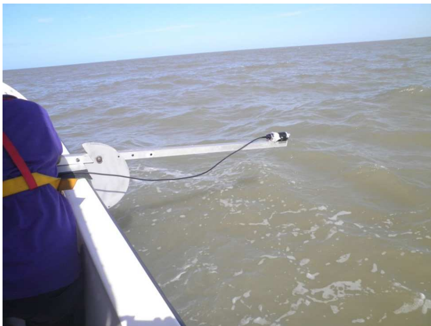
Illustration 5 – Principe de fixation du sondeur monofaisceau
