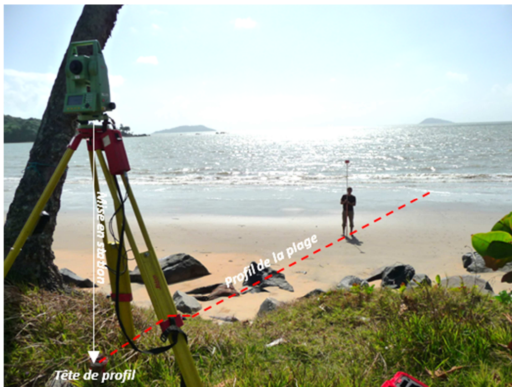
Illustration 7 : Exemple d'un levé de profil de plage au tachéomètre laser
