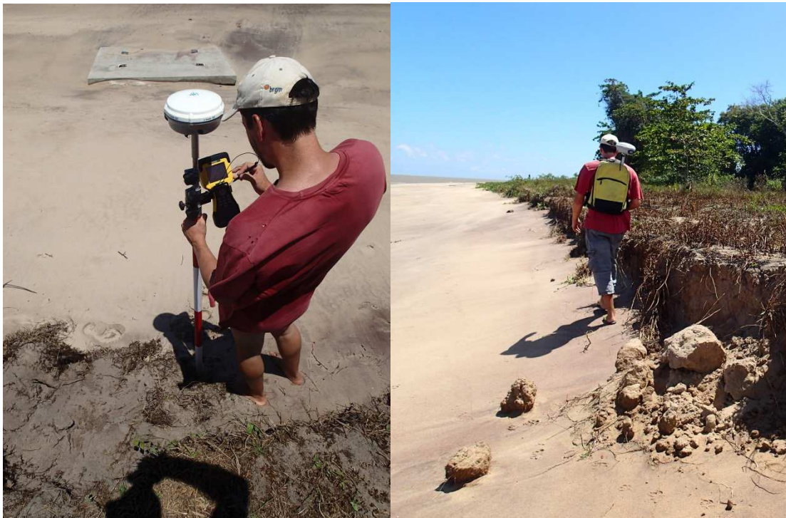
Illustration 3 – Station mobile du GPS positionnée sur une canne pour les profils de plage et sur un sac à dos pour le levé du trait de côte
