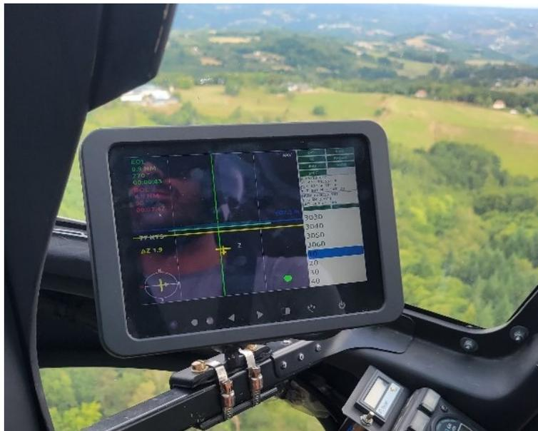
**Figure 9** : Système de navigation embarqué
