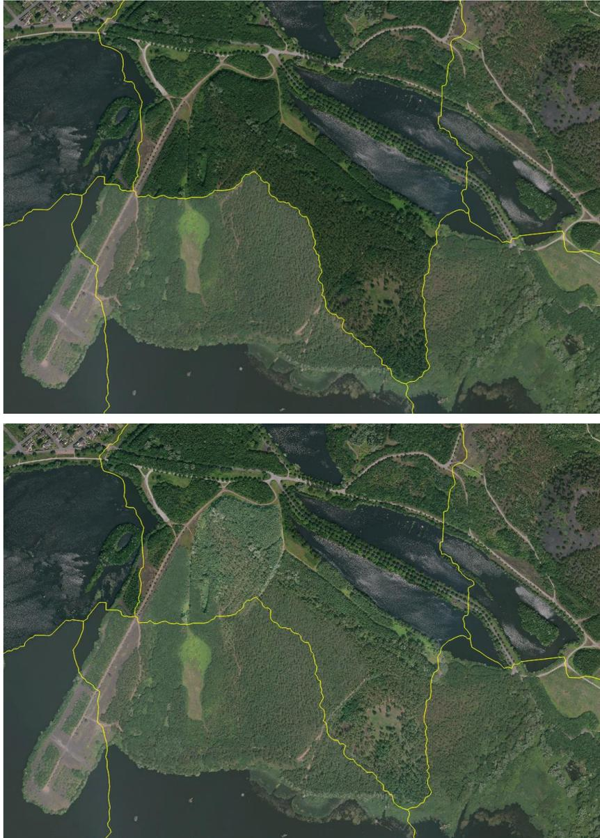
**Figure 1 - défaut radiométrique constaté sur la première livraison (en haut) et après modification du mosaïquage (en bas). On note que le graphe de mosaïquage V2 (en jaune sur l'illustration) ne correspond pas au mosaïquage effectif.**
