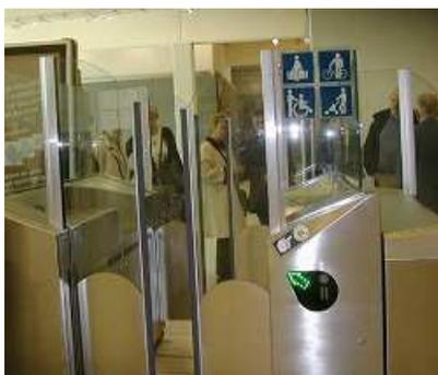
Qu'elles soient encombrées d'une poussette, de bagages, ou bien munies de béquilles ou encore utilisatrices d'un fauteuil roulant, les personnes à mobilité réduite rencontrent des difficultés pour franchir les lignes de contrôle automatique des titres de transport. C'est pour cela que des passages élargis ont été conçus.
